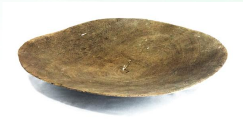
ภาพที่ 2 เสียงอุปกรณ์การร่อนแร่แบบดั้งเดิมเป็นภูมิปัญญาของคนในท้องถิ่น ที่มา : กัมพล มณีประพันธ์และสงบ ส่งเมือง (2529)
